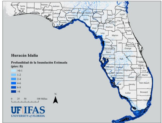
**Figura 3.** Estimación de la profundidad de la inundación ocasionada por el huracán Idalia en Florida.
